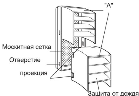
2. Прикрепите комбинированную защитную панель к панели окна. Сильно нажмите на сетку для защиты от насекомых, чтобы ее четыре выступа вошли в отверстия на панели окна. Сторона «А» теперь будет сверху, как показано на схеме, когда она установлена в окне.
